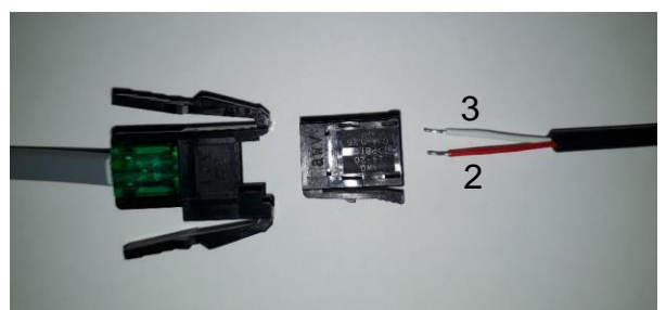
Lämpötila sensorin kaapelien kytkentä
